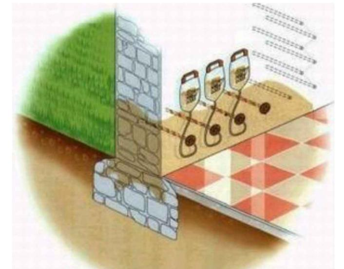
Sbarramento orizzontale al passaggio di umidità di risalita tramite iniezioni
